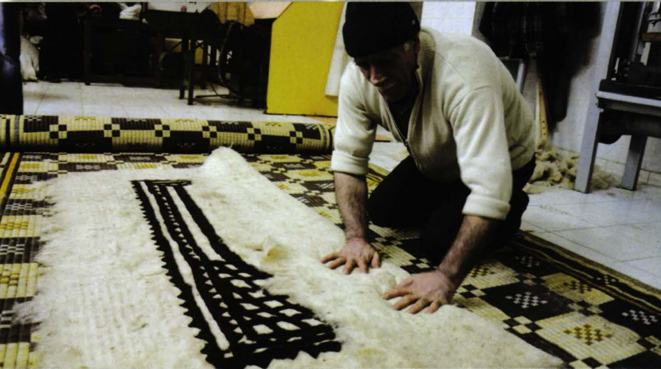
Fotoğraf 85. Keçe Kenarlarının Düzeltilmesi ve Su Serpme İşlemi
