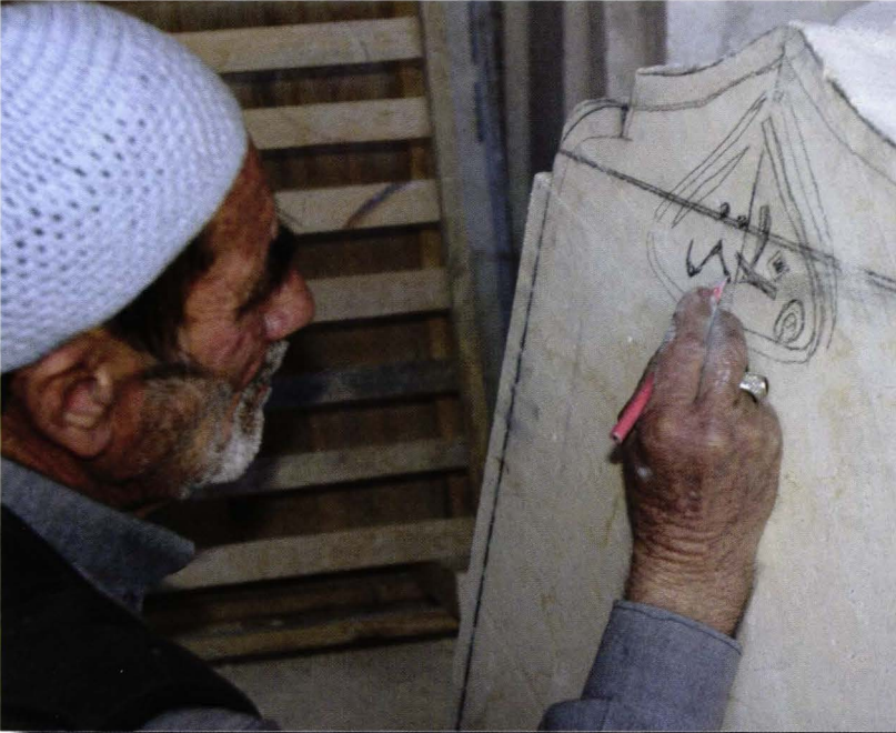
Fotoğraf 119. Desenin Taşa Çizilmesi
