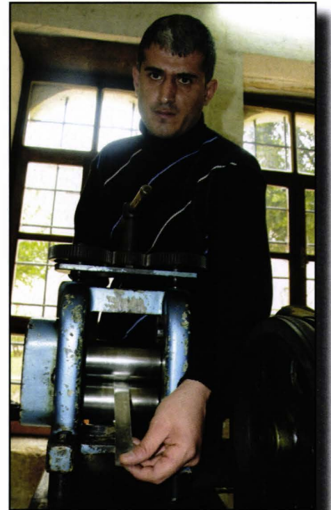
Fotoğraf 183. Silindirden Geçirilerek Plaka Hazırlama
