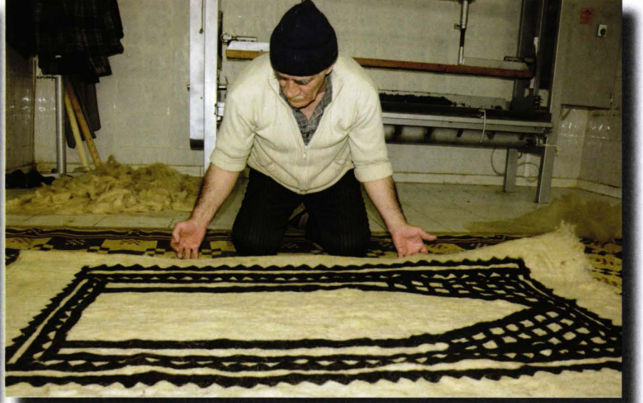
Fotoğraf 84. Keçe Deseninin Hazırlanması Ve Yünün Desen Üzerine Sepki İle Saçılması
