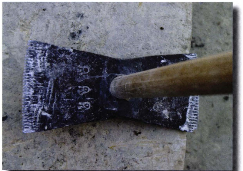
Fotoğraf 120. Yontma İşleminde Kullanılan, “Yonacak” Denilen Alet
