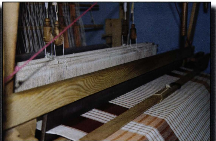
Fotoğraf 57. Mekikli Tezgahın Genel Görünümü ve Mitit, Tarak, Tefe, Gücüler, Köprü, Kuşçağız Bölümleri
