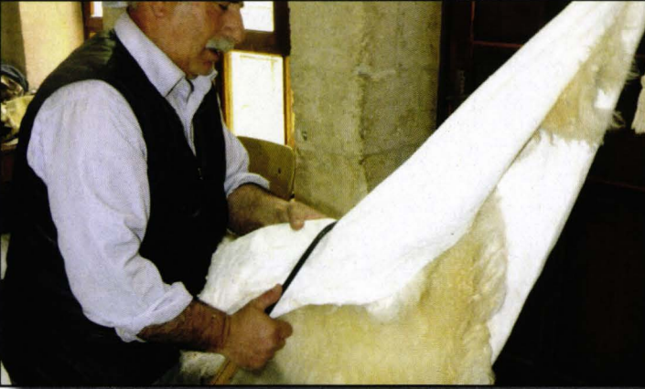
Şekil 204. Yumuşatma, Parlatma ve Zımparalama İşlemi
