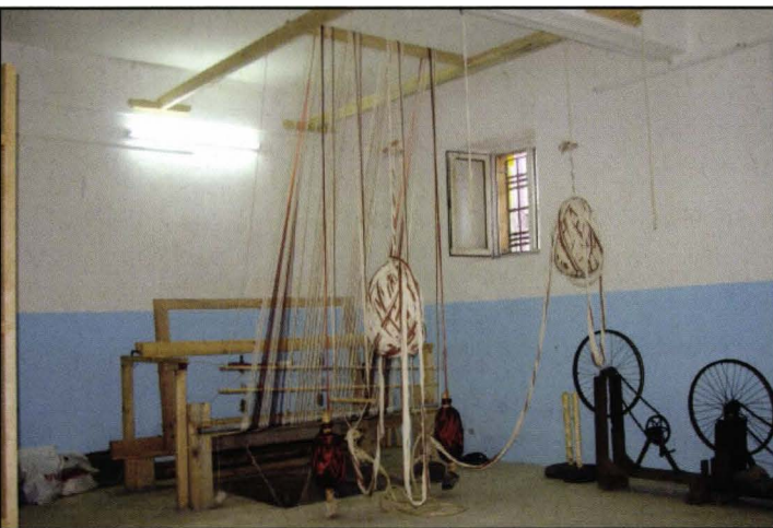
Fotoğraf 57. Mekikli Tezgahın Genel Görünümü ve Mitit, Tarak, Tefe, Gücüler, Köprü, Kuşçağız Bölümleri
