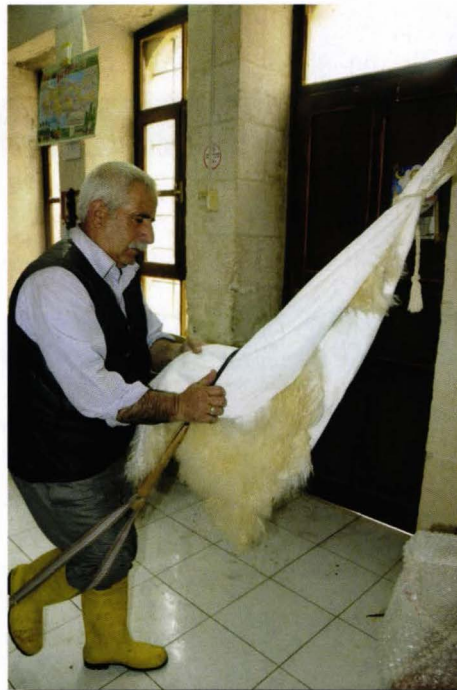
Şekil 195. Doğunluk Aracı ve İşleminin Yapılması
