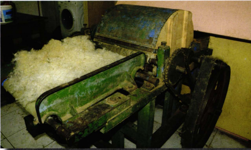
Fotoğraf 83. Yün Elyafın Hallaç Makinesinde Atılması
