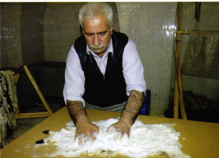
Şekil 198. Derinin Deterjanla Ovlulması
